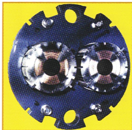
Coupe transversale de la masse froide (1,8K) du quadripôle 2 en 1 pour LHC.
