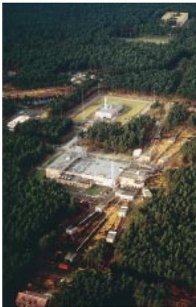
Photo aérienne du centre EURATOM de Geel, en Belgique où la DSM participe à des mesures de sections efficaces de capture de neutrons par des noyaux, en vue d'étudier la transmutation des déchets nucléaires à vie longue. On distingue les « lignes de temps de vol » où l'on mesure la vitesse, donc l'énergie des neutrons
