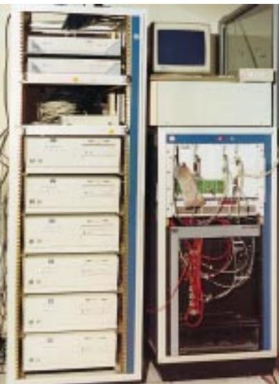
Les sources de données figurant les mémoires tampon liées aux capteurs du détecteur sont les cartes électroniques placées dans la partie haute du châssis de droite. Les unités de traitement sont les ordinateurs personnels dépourvus d'écran placés à gauche. Le commutateur ATM reliant tout ses éléments est la « boîte noire » placée en bas à droite.
