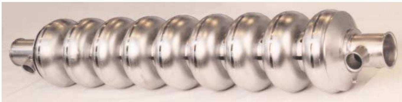
Cavité supraconductrice type TESLA 9 cellules.
