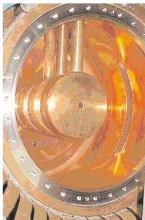
Vue intérieure du prototype de DTL (Drift tube linac), section rectiligne de l'accélérateur linéaire de protons IPHI.
