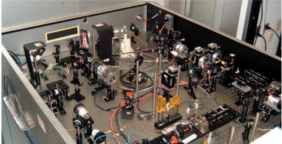
Figure 3 : Source de lumière laser polarisée de l'expérience Happex
