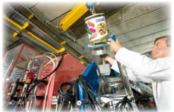
Installation du détecteur de gammas Exogam au point cible du spectromètre Vamos (Ganil).
