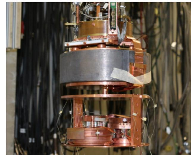
*détecteur ID installé pour test au LNGS*
