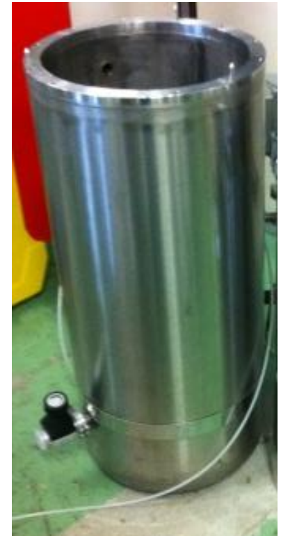
« Chaussette » d'un cryostat
