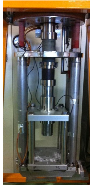
Cryostat supportant 8 tonnes en traction 15 en compression
