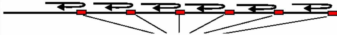
N capteurs à réseaux de Bragg
