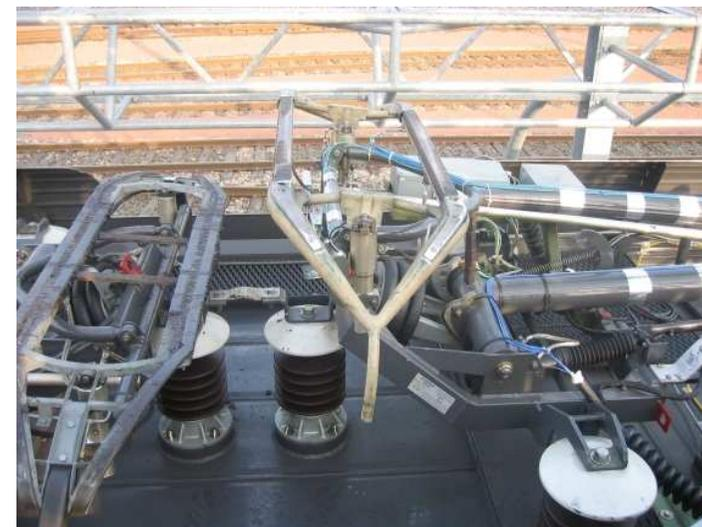
instrumentation des Pantographes
