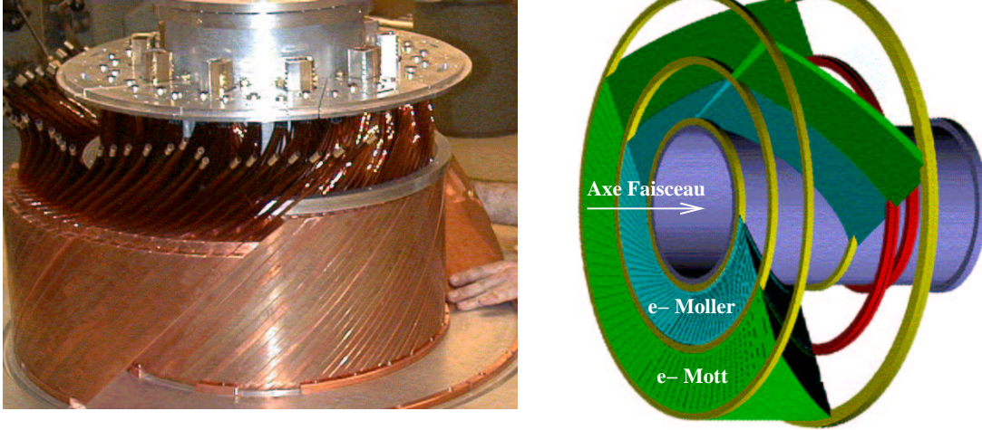
Figure 27: Gauche: Détecteur d'électrons de E158 en construction. Le plateau supérieur assure la connexion entre les fibres optiques et les PM. Droite: Illustration du positionnement des plaques de cuivre entre lesquelles sont disposées les fibres de quartz.
