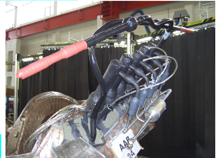
Zeitz, 19. 1. 2005 AAB24 Paschentest Durchschlag an J1 bei 9kV und 0,1 mbar
