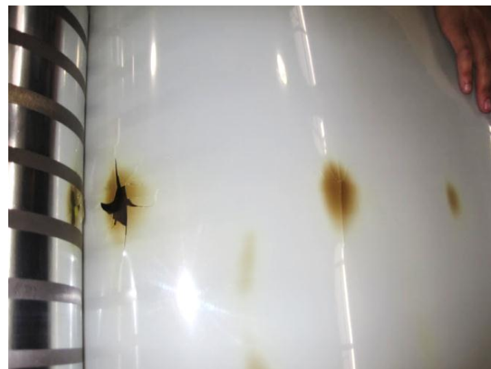
Isolant HT (mylar) endommagé"
